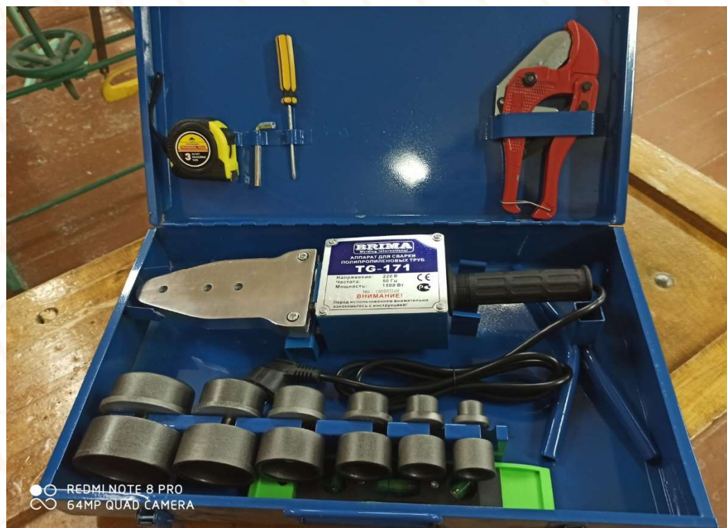
Аппарат для раструбной сварки пластиковых труб
